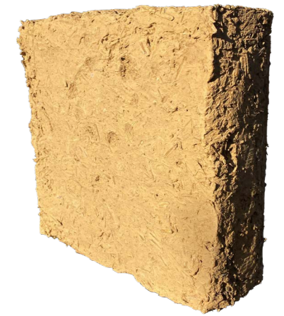
Test 3: Mischungsverhältnis: 57% Hanfschäben 43% Lehmpulver
