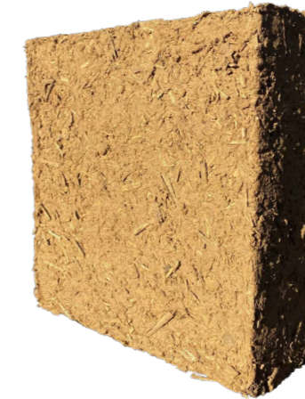
Test 2: Mischungsverhältnis: 66% Hanfschäben 34% Lehmpulver
