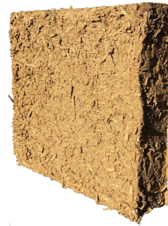
Test 1: Mischungsverhältnis: 80% Hanfschäben 20% Lehmpulver
