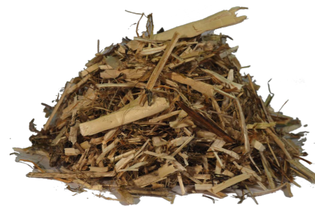
Hanfschäben: Gebrochene Hanfstängel, die wegen der staken Fasern gut als Armierung verwendet werden können
